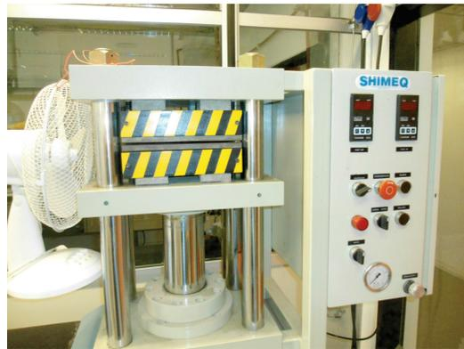
Figura 5.6: Foto de la prensa utilizada para la microfabricación de las líneas de transmisión.
