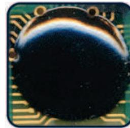
Figura 5.2: Foto de un chip electrónico encapsulado con resina.
