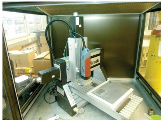
Figura 5.8: Foto de la fresa mecánica que realiza los via holes.
