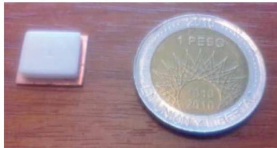
Figura 5.32: Foto del desplazador de fase *MEMS* con líneas cargadas fabricado con caja, encapsulado.
