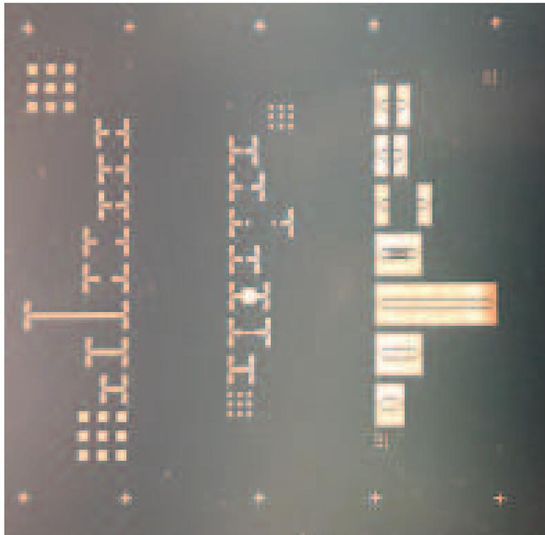
Figura 5.12: Máscara fabricada y colocada en el marco.
