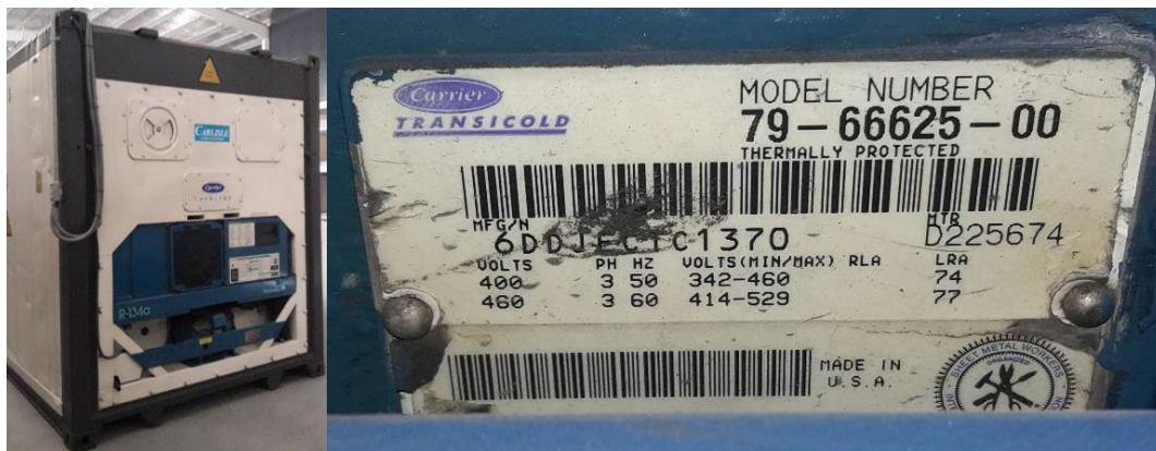
Imagen 9: A la izquierda, se observa el contenedor frigorífico con una potencia nominal de 7,5HP. A la derecha, se observa la chapa característica del mismo.
