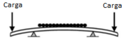
Figura 8: Esquema de un sistema que utiliza flexión del sustrato (adaptada de [10]).
