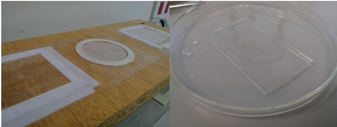
Figura 17: Izq, imagen del molde para el curado de la silicona. Der, imagen de la membrana curada.
