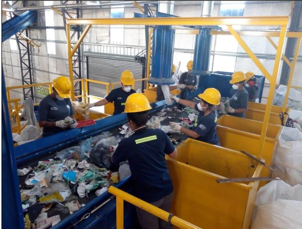
Imagen VIII: Cinta de separación y clasificación de material reciclable del CV Barracas, CABA, 2019 (Imagen facilitada por un RG)
