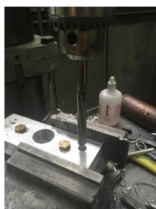
La siguiente imagen es del mecanizado del husillo de motor para poder adaptarlo al soporte.
