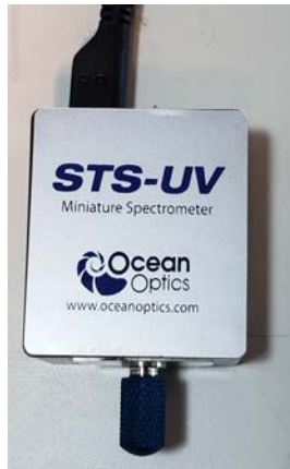
Fig. 16 Espectrofotómetro para toma de la emisión del plasma y creación del espectro digital
