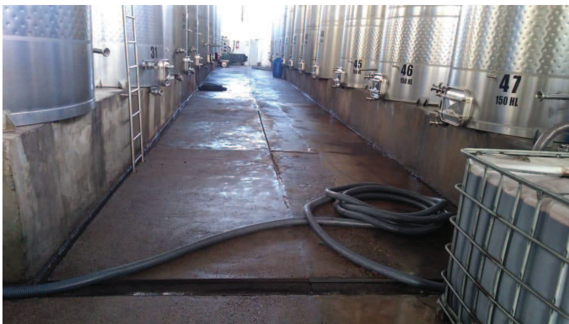
Fig. 4.1: Uno de los tres pasillos característicos de la bodega, con su canaleta correspondiente. En la foto puede verse también la manguera con la que se realiza el trasiego del vino. Fuente: Elaboración propia, 2018.
