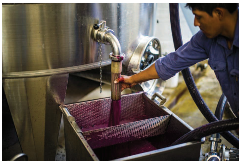
Figura 2.7: Proceso de remontaje donde se puede observar como hacen recircular el mosto dentro de la cuba. Fuente: La Gaceta, 2015.
