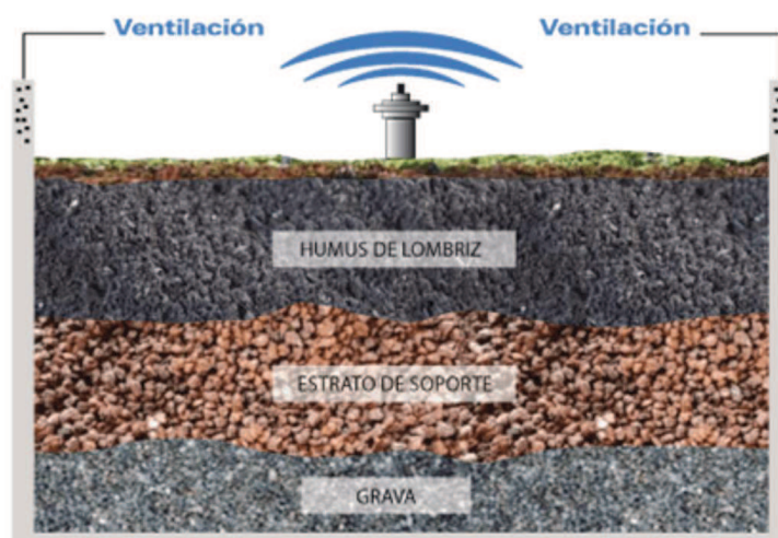
Figura 5.12: Estratos que componen el lombrifiltro. Fuente: Ciclo perfecto, 2017.
