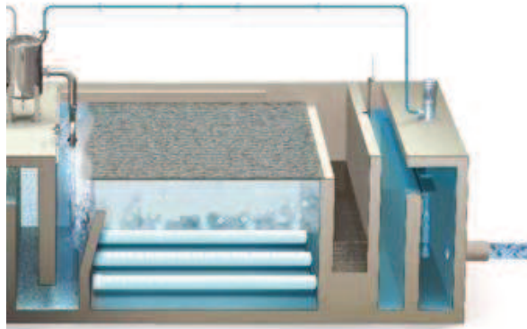
Figura 5.7: Sistema de difusión por aire disuelto con bomba de reciclo presurizado de 5HP. Fuente: Evoqua, 2018.
