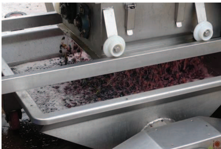
Figura 2.4: Unidad de molino de rodillos. Fuente: Cata del Vino, 2014.
