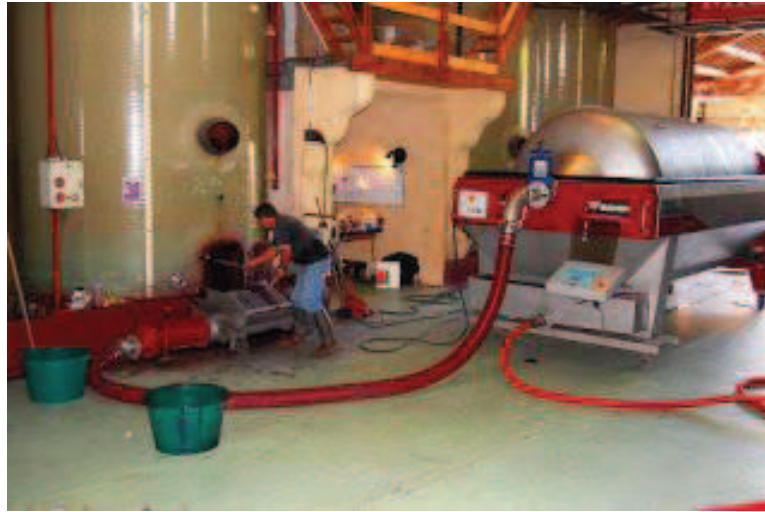
Figura 2.10: El orujo, con gran contenido de líquido, es bombeado a la prensa horizontal. Fuente: Urbina Vinos, 2017.
