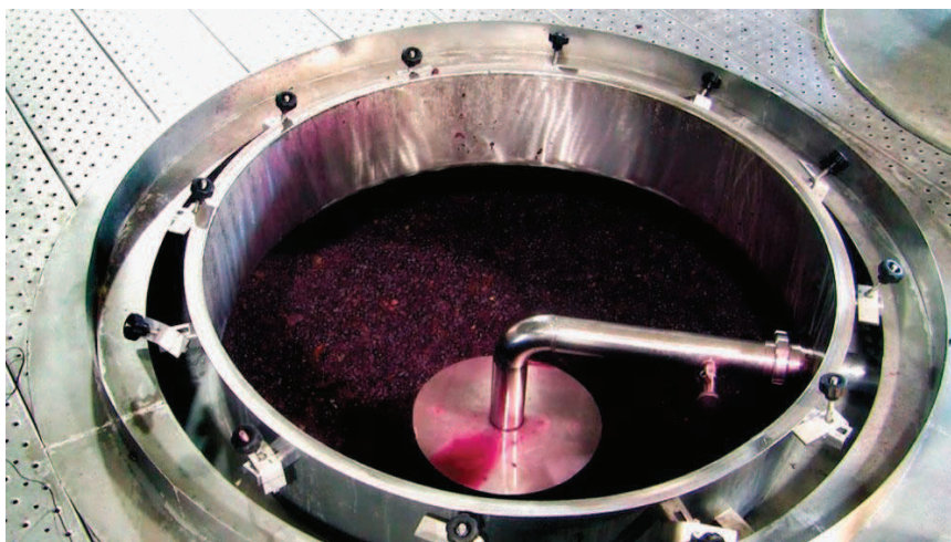
Figura 2.5: Cuba de almacenaje para el mosto con el orujo donde se produce la etapa de maceración. Fuente: Vinopedia, 2018.
