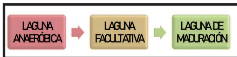
**Figura 4.1. Esquema de un sistema de tratamiento por lagunas de estabilización. Fuente: UNSAM**
