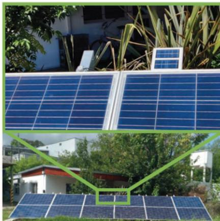
Figura 136 - Montaje del radiómetro y arreglo de paneles solares de la alimentación del nodo.
