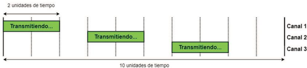
Figura 59 - Representación del ciclo de trabajo para 3 canales.
