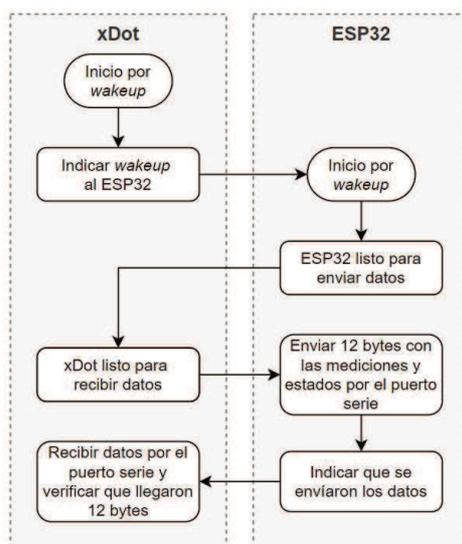
Figura 139 - Lógica de intercambio de datos entre los dispositivos.
