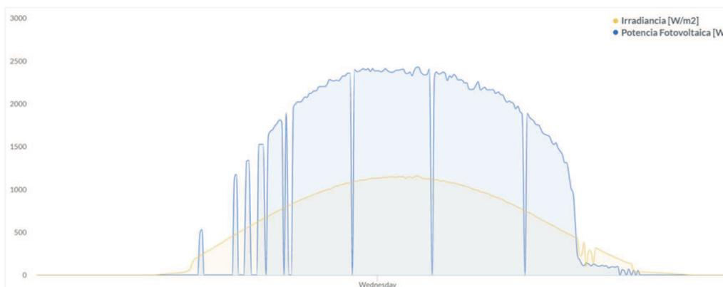
Figura 186 – Intermitencia observada en los datos de potencia generada para el día 16/03/2022.
