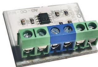
Figura 114 - Placa del amplificador de transresistencia con borneras para la calibración.
