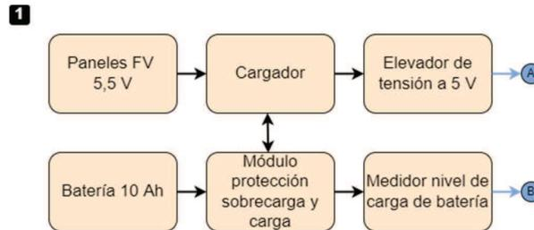
Figura 96 - Diagrama en bloques del módulo de alimentación del sistema.
