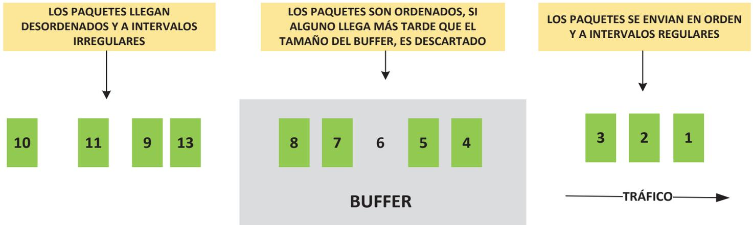
Figura 20: Funcionamiento del buffer.
