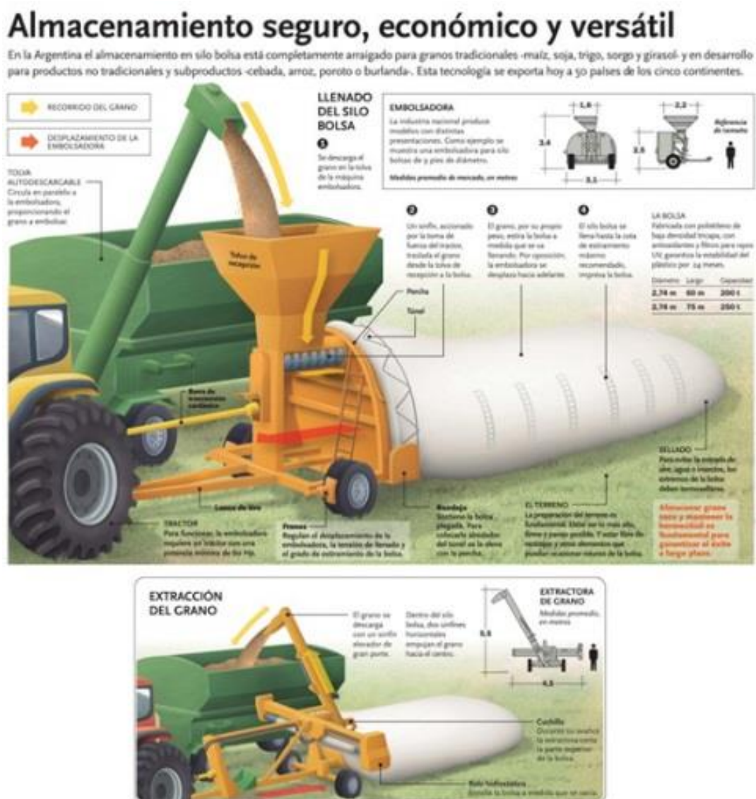
Figura 7: fases de almacenamiento y extracción de granos en el sistema de embolsado. INTA Informa (2015)
