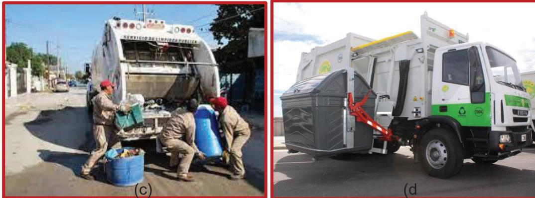
Figura 4-IV Tipos de vehículos recolectores de residuos. a) Camión grúa; b) Camión roll off con volquete; c) Camión compactador con carga manual; d) Camión compactador con carga mecanizada.
