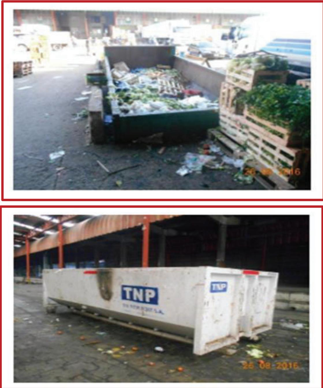
Figura 2-XVIII Contenedores tipo Roll off de 14 m<sup>3</sup> (izquierda) y de 20m<sup>3</sup> (derecha) del área transaccional. Fuente: (INTI M. P., 2016)
