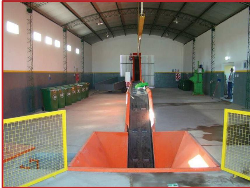
Figura 5-XIII Ejemplo de tolva para la descarga de residuos, con cinta elevadora. Fuente: Deisa
