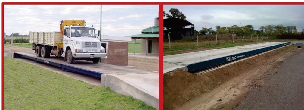
Figura 5-XII Báscula electrónica para pesar camiones. Fuente: Magnino
