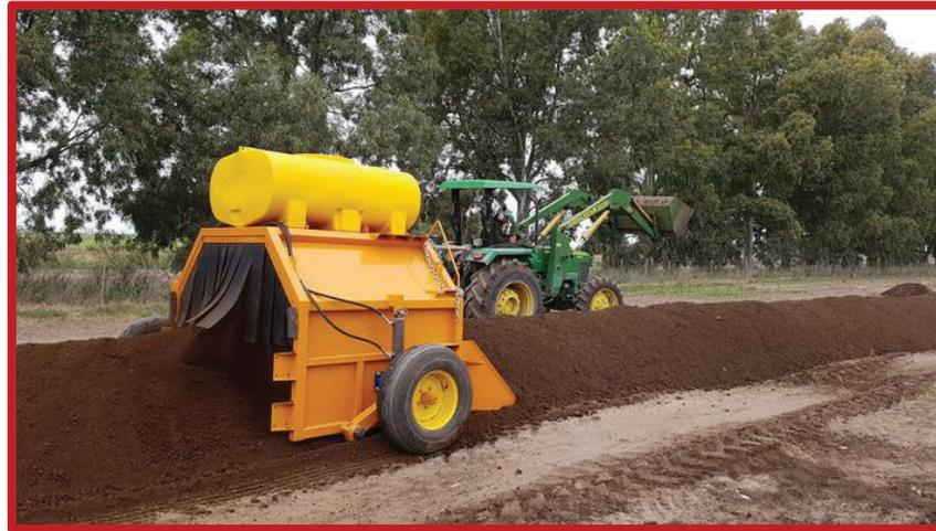
Figura 5-XXIX Removedora de compost RCO en acción, traccionada por una pala cargadora.
