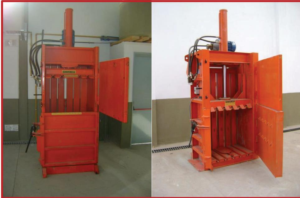
Figura 5-XVII Prensa vertical hidráulica. Fuente: Deisa
