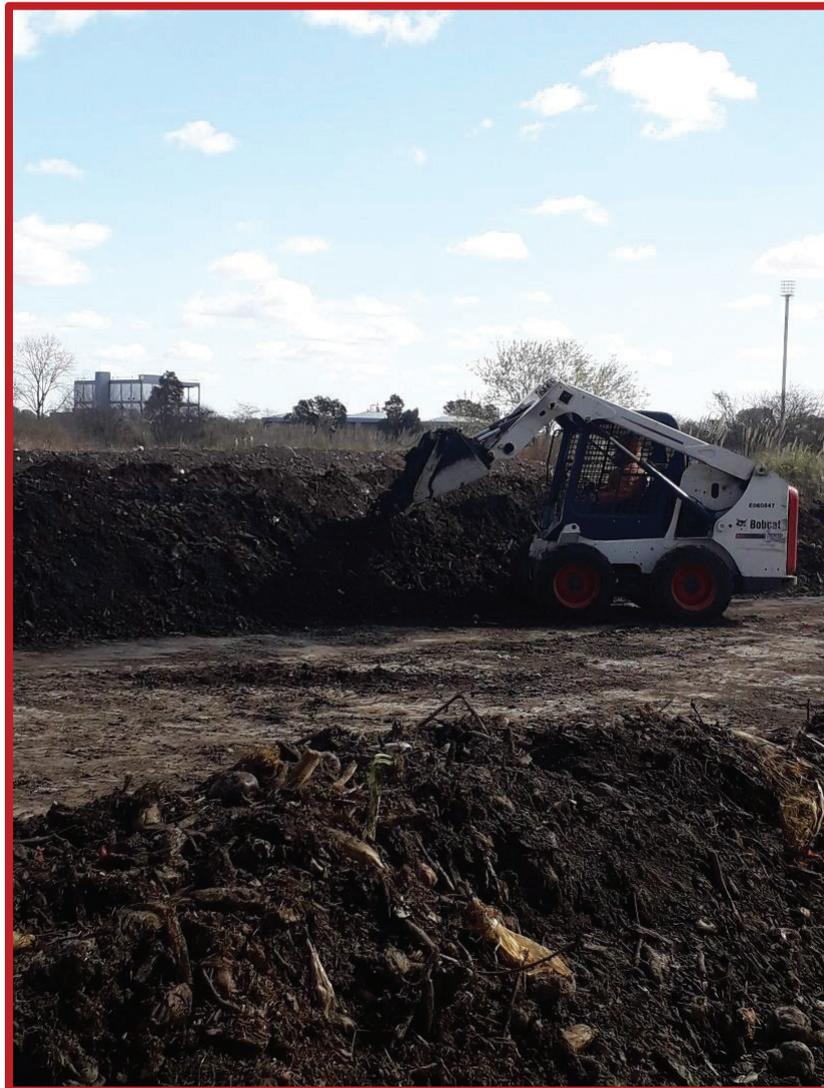
Figura 2-XXVIII Pala cargadora realizando volteos de hilera de compostaje. Fuente: Propia en visita al MCBA.
