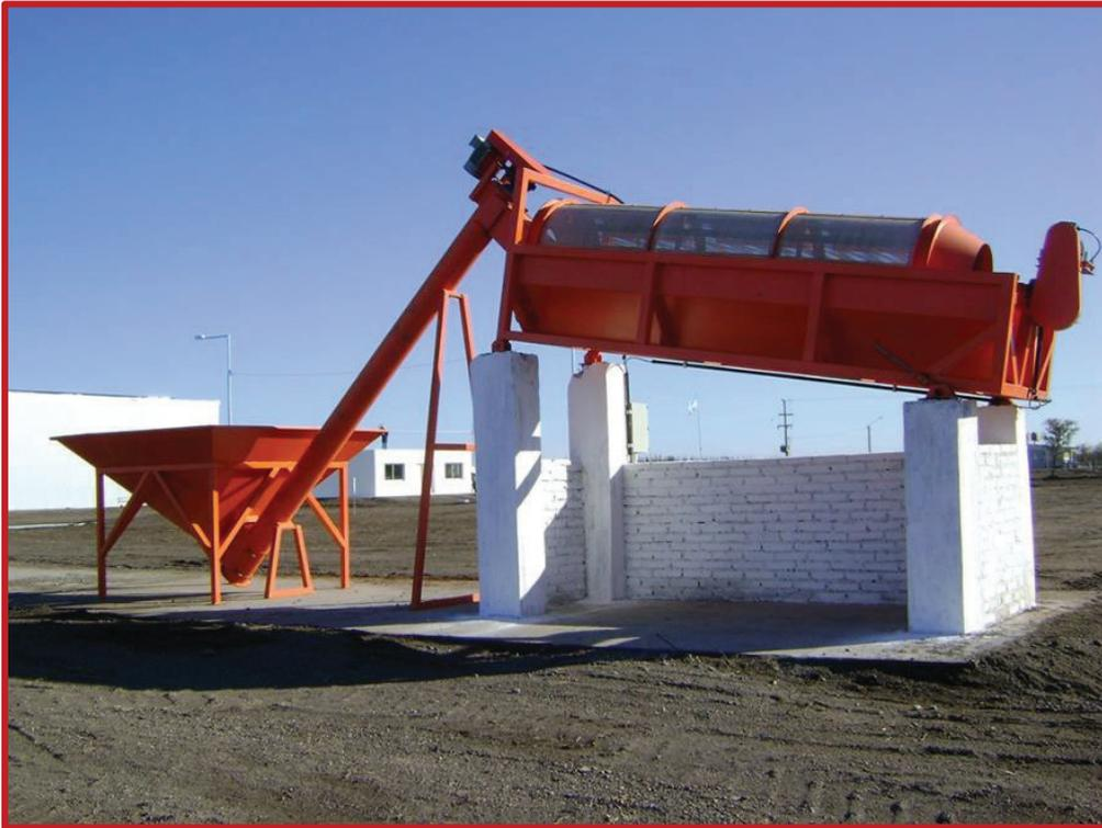
Figura 5-XXXII Trómel para tamizado de 25 mm con tolva de alimentación. Fuente DEISA.
