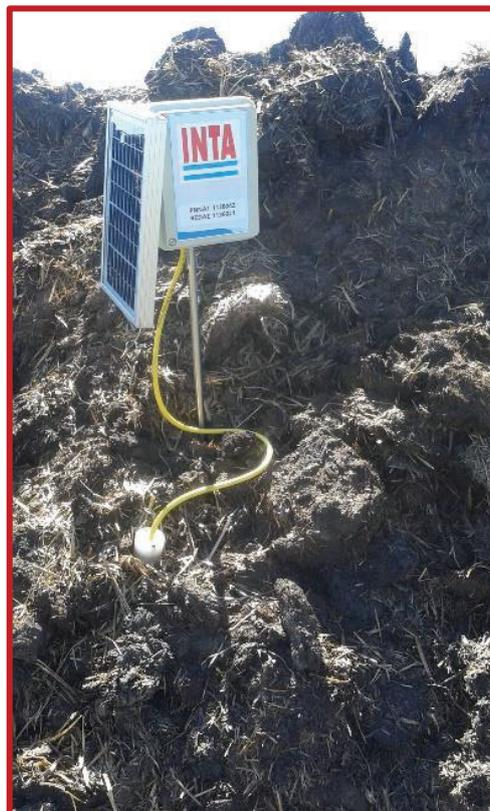
Figura 5-XXI Sensor para medir temperatura y humedad del compost. Fuente: INTA
