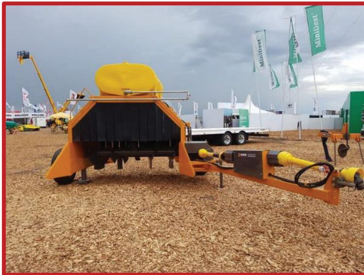
Figura 5-XXVIII Removedora de compost RCO con aspersion. Fuente: El Pato maquinas agricolas SRL.
