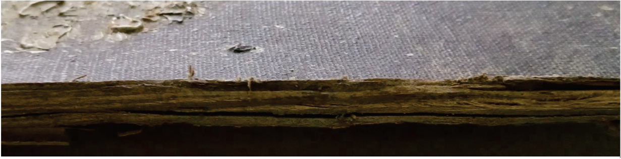
Fig. 38: Delaminación del cartón original.
