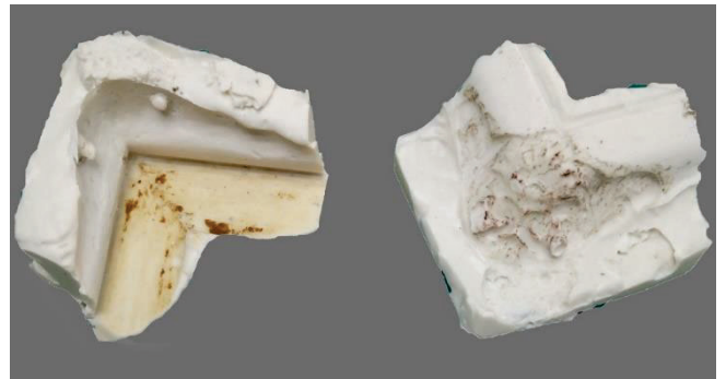
Fig. 61: Moldes de alginato.
