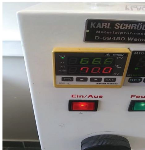
Foto 3: Muestra de la cámara de envejecimiento regulando la temperatura y la humedad
