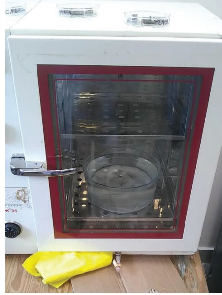
Foto 9: Cámara cerrada con las muestras siendo sometidas a envejecimiento.
