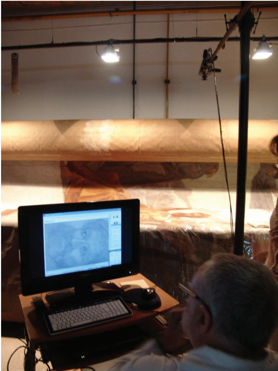
Figura 29: Equipo para el análisis multiespectral de imágenes ARTIST 2000, montado sobre la obra.
