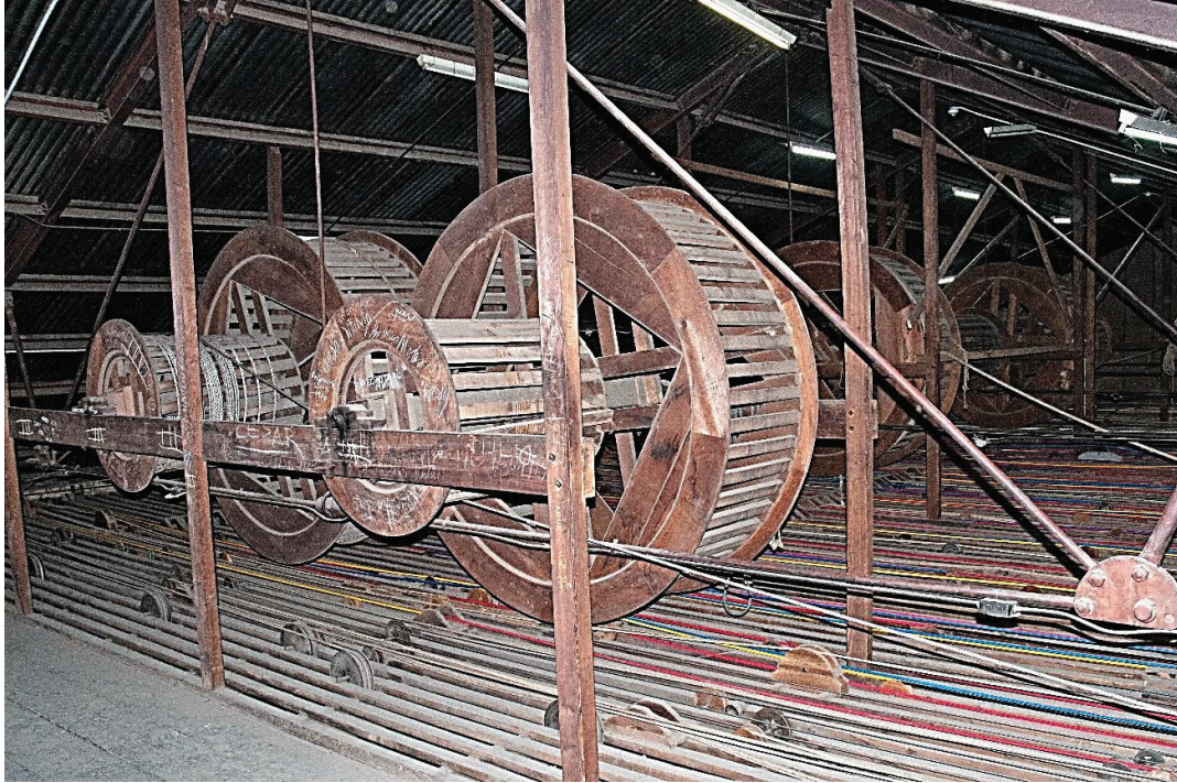
(Figura 10) Sistema de tambores Tiri in botte del telón principal del teatro Libertador de Córdoba
