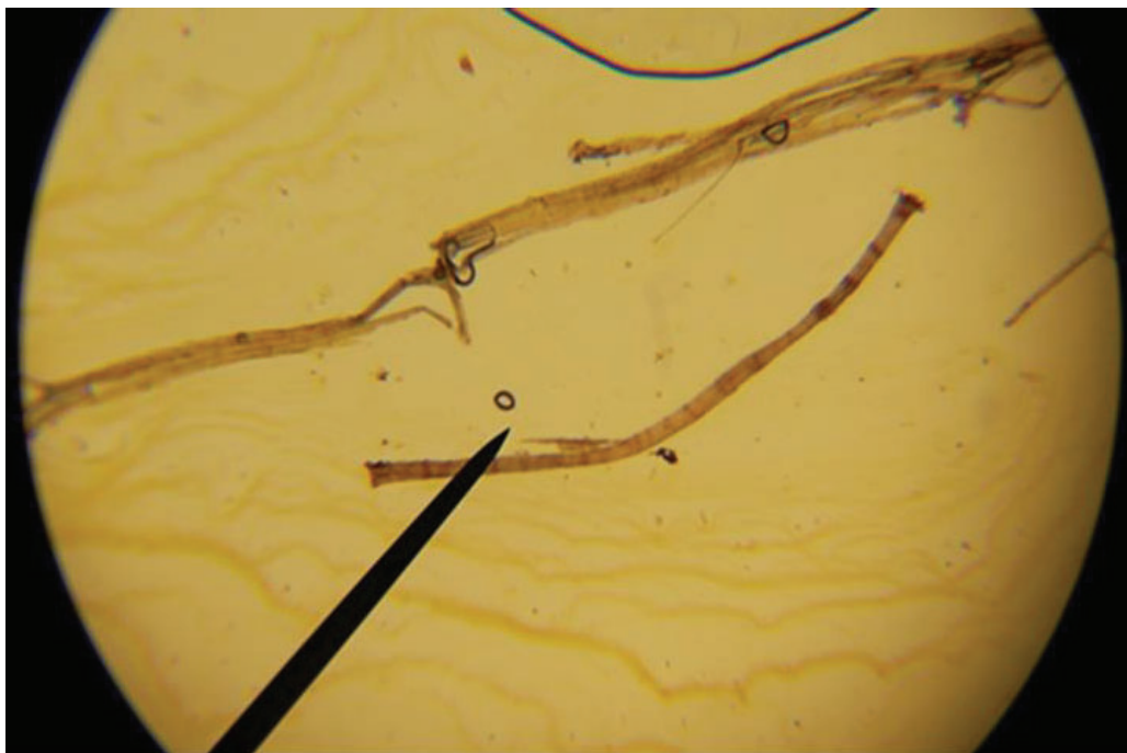
Figura 24: Detalle de una fibra de lino del telón, en 200 X con luz transmitida.
