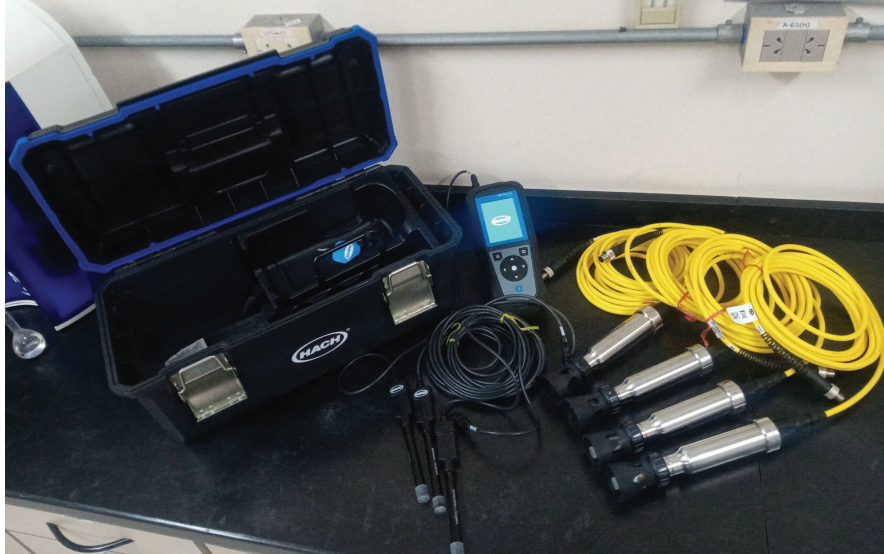
Figura V.16. Equipo multiparamétrico de campo HACH 4300 HQ con sonda de ion selectivo para cloruros.
