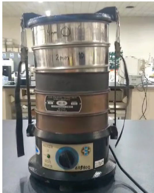
Figura V.18. Zarandeadora con tamices de 4 mm, 2 mm, 600 \mu\text{m} y 425 \mu\text{m} para el ensayo de caracterización del sustrato.
