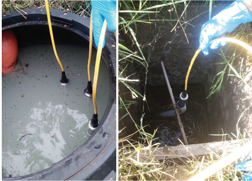
Figura V.23. Determinación de parámetros in-situ con la sonda multiparamétrica HACH - HQ 4300
