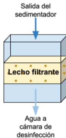
Figura III.4. Esquema general de un filtro. Fuente: Elaboración propia.
