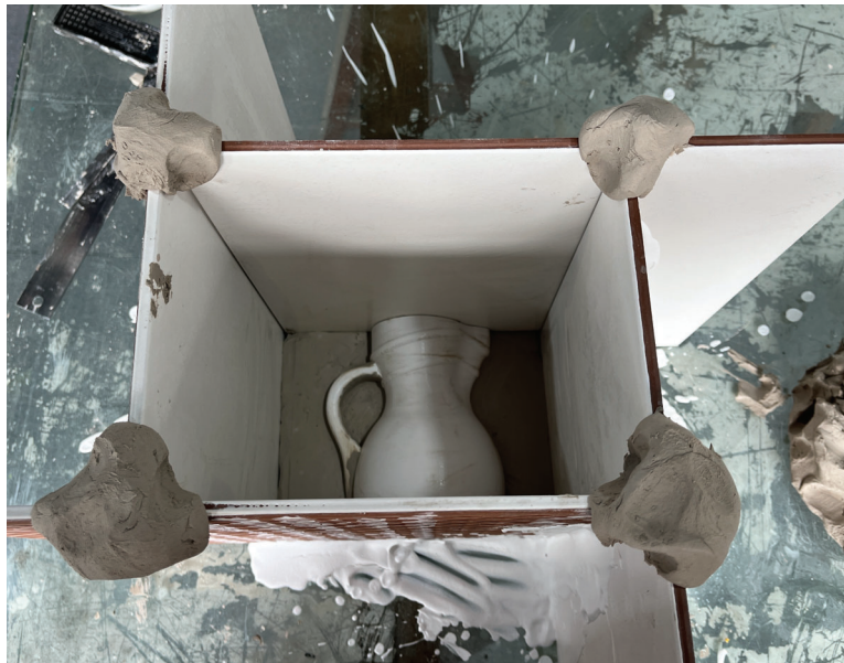
Imagen 50-Vista del encofrado y uniones con arcilla
