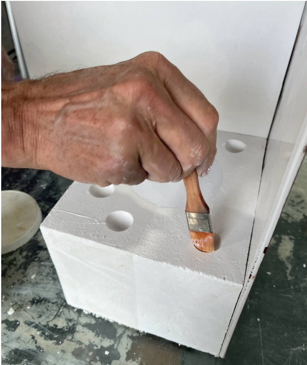
Imagen 56- Aplicación del desmoldante sobre la superficie del tacel que tomará contacto con la colada de yeso del tercer tacel- Colaboración Profesor Hugo Ostermann
