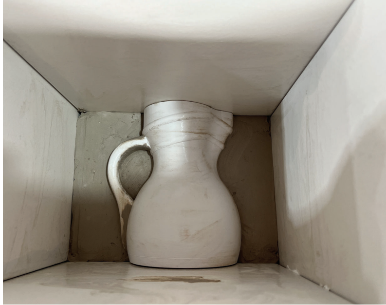
Imagen 51 - Modelo de PLA sobre la cama de arcilla vista dentro del encofrado Fotos MAB 2023
