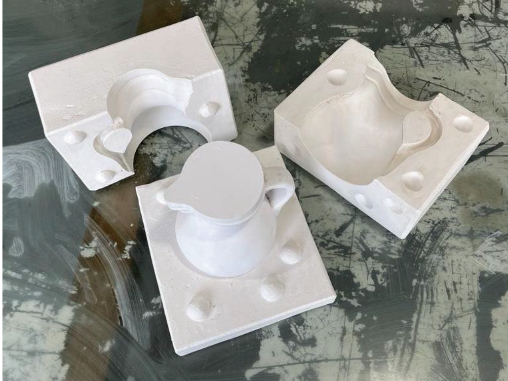
Imagen 60 - Modelo impreso en PLA y tres taceles del molde de yeso tipo París Foto MAB 2023
