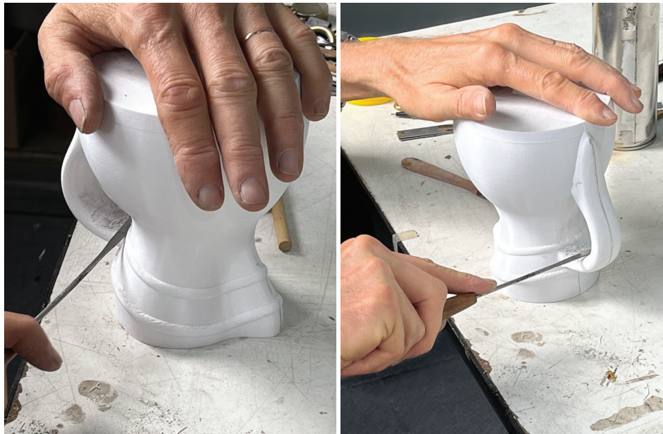
Imágenes 43 y 44 Eliminación de rebarbas producidas en la impresión 3D Colaboración Profesor Hugo Ostermann- Fotos MAB 2023
