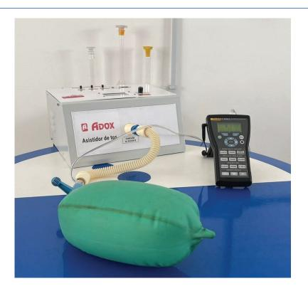
Figura 6.1.: Disposición del prototipo asistidor de tos con el instrumento de medición de flujo de gas, marca Fluke, modelo VT Mobile, y bolsa de prueba de 2 L.
