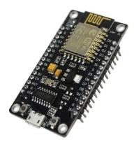
Figura 5.7.: Placa de desarrollo NodeMCU V2
