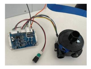
Figura 5.3: Turbina eléctrica conectada con el driver y el potenciómetro, marca Wonsmart.
