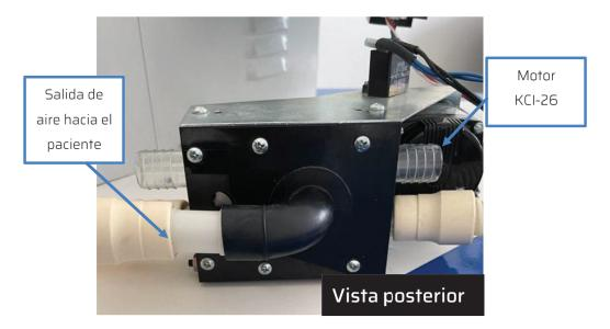
Figura 5.5.b: Vista posterior del conjunto válvula de cambio de sentido y motor.
