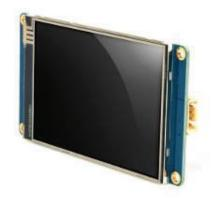
Figura 5.8.: Display de 3.5 pulgadas, de la marca Nextion, modelo NX4832T035.
