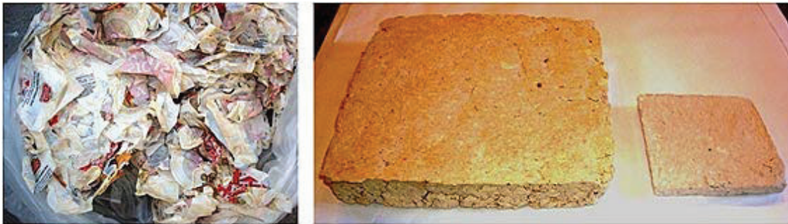
Figura 13. Aislante térmico con etiquetas de cerveza desechadas 53
