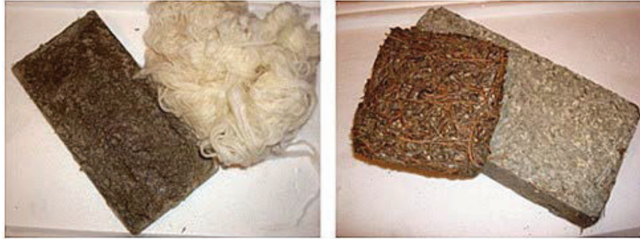
Figura 12. Ladrillo con lana de oveja (izq.) - Ladrillo con agujas de pino (der.) 52
