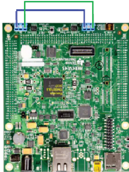
Figura 56: Puente entre ambos puertos CAN de la POBC
