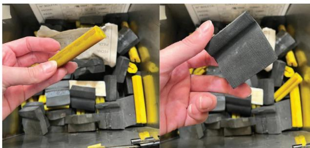
*Figura 6. Separadores utilizados en el proceso de vidrio automotriz.*
