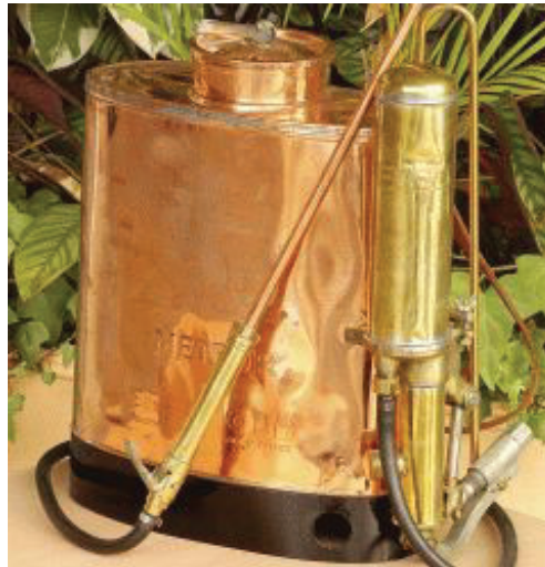
Figura 1.1.4.2. Equipo pulverizador manual (mochila) de 1887.
