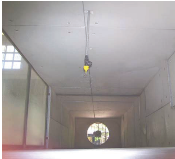
Figura 2.3. Pastilla colocada en posición de trabajo dentro del túnel de viento.
