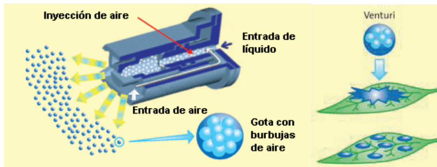
Figura 1.1.4.3. Vista en corte de una pastilla asistida por aire. Fuente: http://www.agrotop.com/?contentid=1&keyid=1&lang=en&navid=2&subkeyid=2
