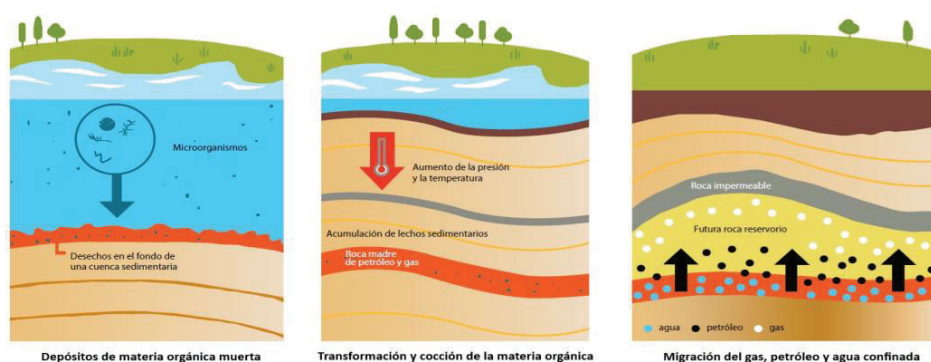
Figura 2.4: Proceso de formación del petróleo y gas natural 12 . Fuente: IAPG
