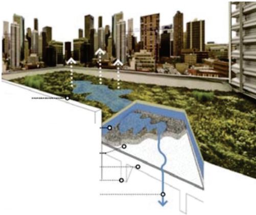
Imagen N° 12. Ejemplo de funcionamiento de techo verde. Fuente: Perales Momparler (2019).
