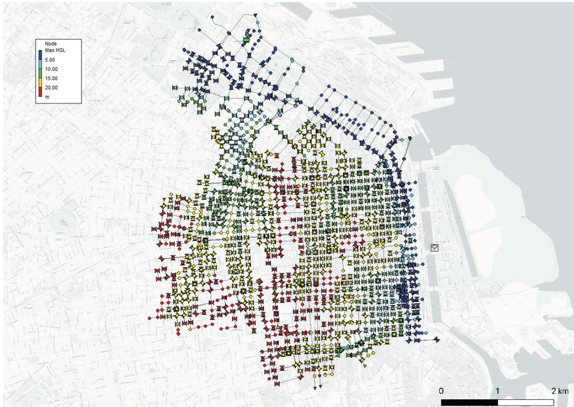
Imagen N° 54. Elevación máxima del agua en los nodos (m). Fuente: elaboración propia en base a simulación realizada en SWMM.
