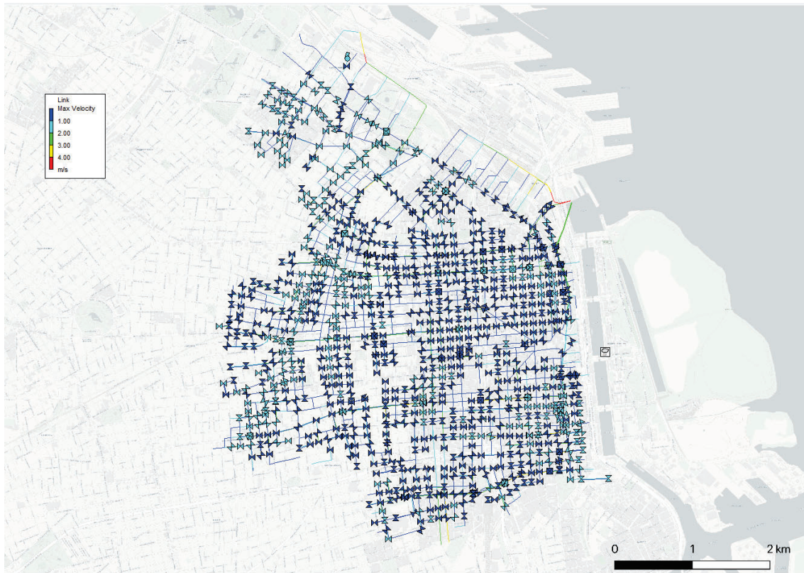
Imagen N° 49. Velocidad máxima de los conductos y calles. Fuente: elaboración propia en base a simulación realizada en SWMM.
