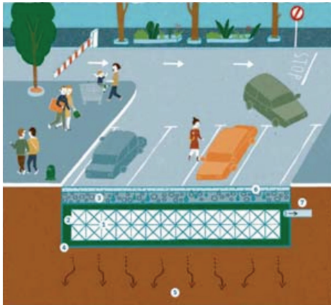
Imagen N° 21. Ejemplo de depósito de infiltración Fuente: Perales Momparler (2019).
