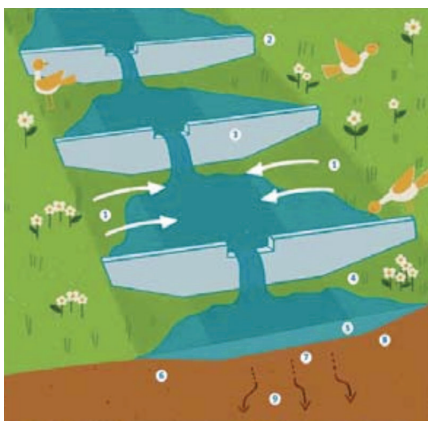
Imagen N° 26. Ejemplo de cuneta verde Fuente: Perales Momparler (2019).
