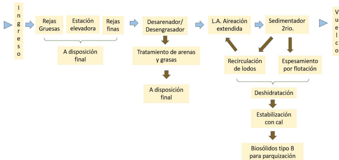
Figura 58: Diagrama de bloques de la planta depuradora. Flechas azules indican línea líquida, mientras que las marrones indican barros del proceso. Elaboración propia.
