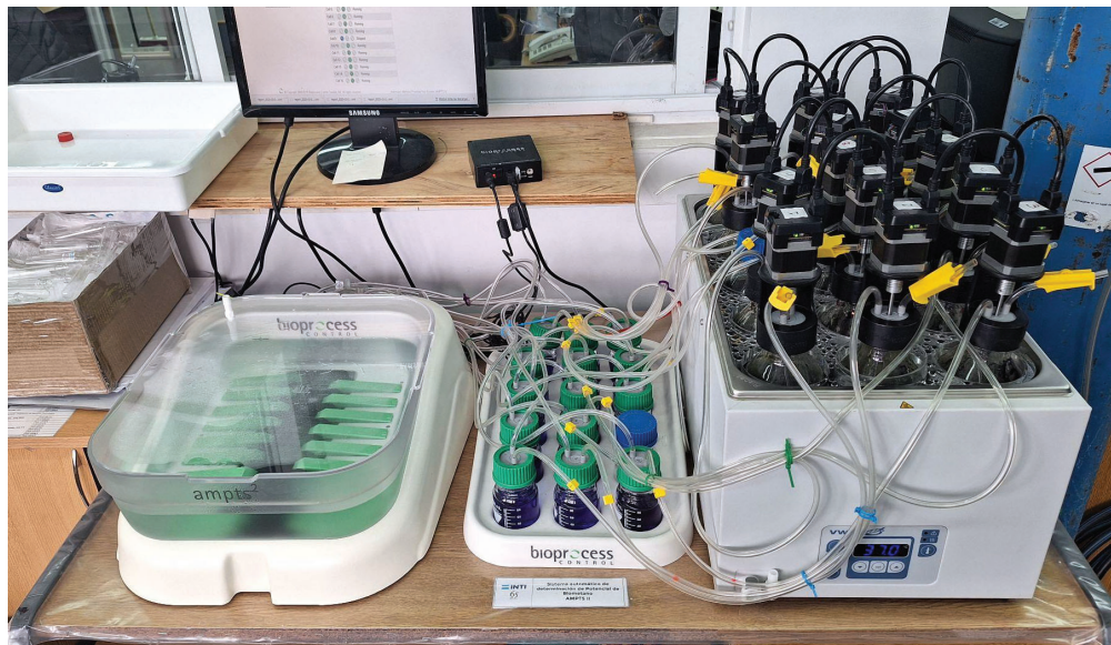
Figuras 4.2.A y B. La primera muestra los seis reactores compuestos por el inóculo y sustrato a diferentes relaciones S/I. La segunda es el equipo armado.
