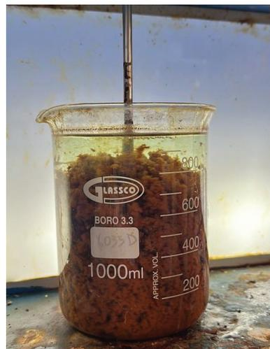
**Figura 4.2 :** Efluente industrial en constante agitación. **Figura 4.3:** efluente industrial en agitación constante con agregado de cloruro férrico y cal.
