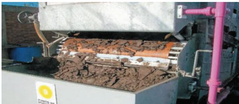
**Figura 4.9:** Instalación de filtros de banda Fuente Marín, A., & Osés, M. 2013
