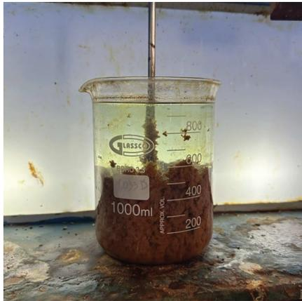
**Figura 4.4:** Efluente industrial luego del agregado de polímero
