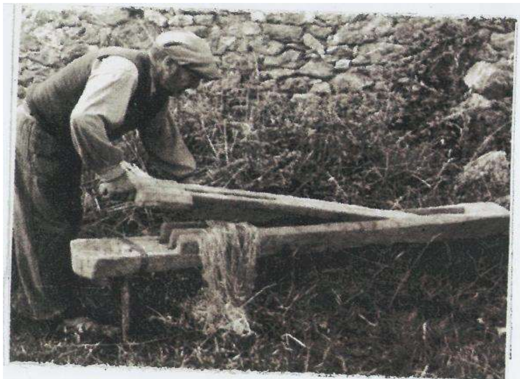
8. Agramadera. Herramienta para agramar (machacar el tallo del lino para obtener fibra textil).
