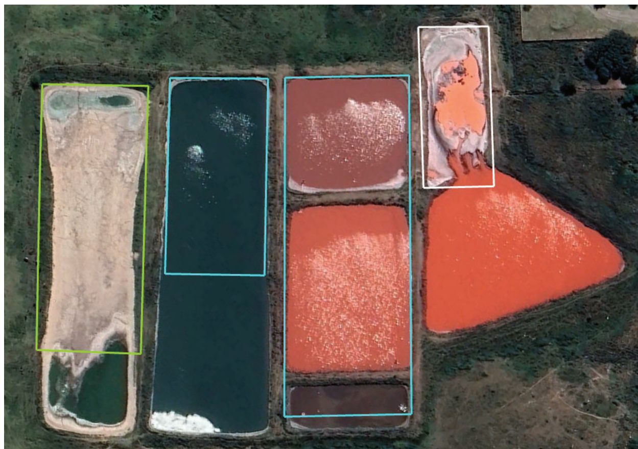
Figura 16. Imagen satelital del sistema de lagunas actual del matadero, con las demarcaciones para las nuevas delimitaciones de éstas en el caso de aplicar la Alternativa 1.
