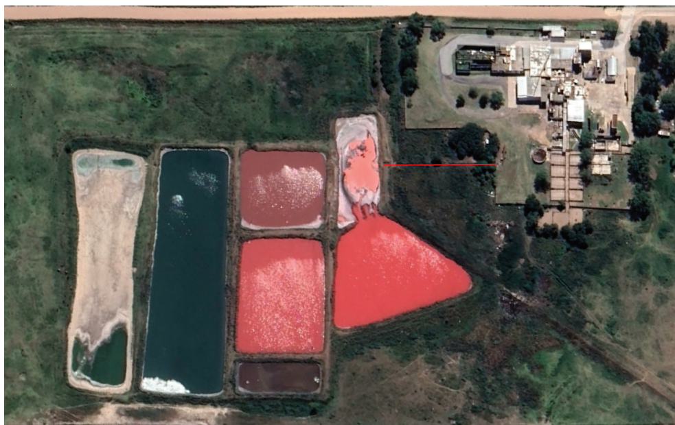
Figura 2. Imagen satelital del matadero y frigorífico de Bragado junto con su sistema de lagunas. En rojo se marca la canaleta de alimentación a éstas. Fuente: Elaboración propia.
