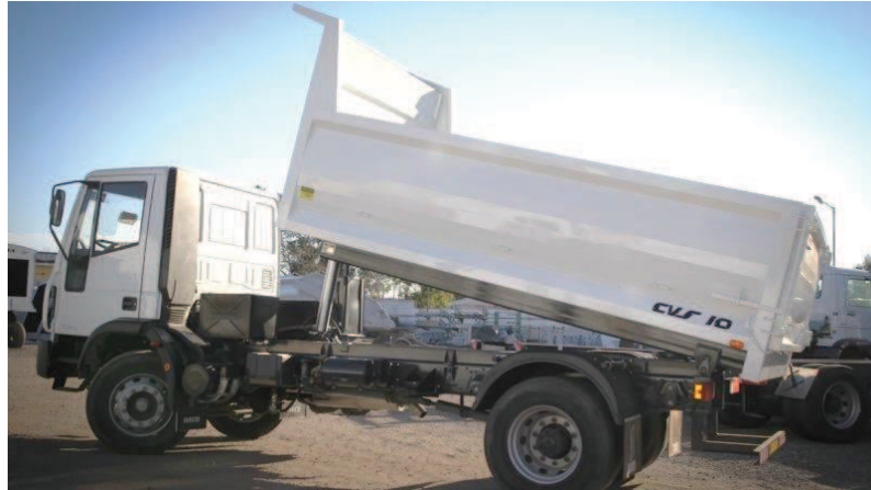
Figura 4.18: Ejemplo de camión con caja volcadora hidráulica. Fuente: Luis J. D. Scorza y Cía. S.A.
