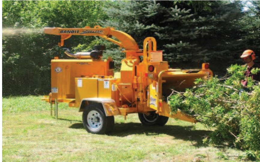
Figura 4.19: Ejemplo de máquina chipeadora, para la trituración de ramas finas. Fuente: Econovo-Oscar Scorza Equipos y Servicios S.R.L.
