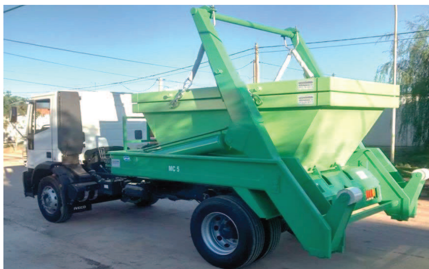
Figura 4.20: Ejemplo de camión autocargador con 2 volquetes de 5 m 3 apilados. Fuente: Cerquatti Metalúrgica.
