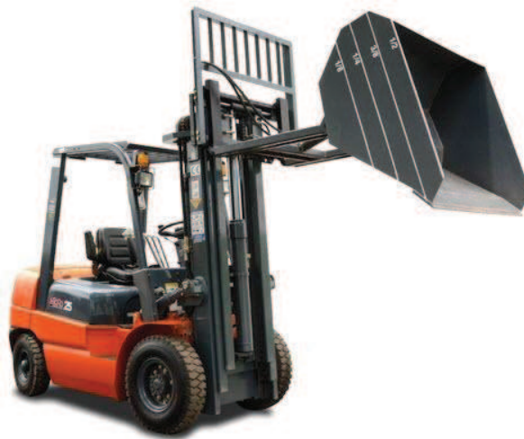
Figura 4.21: Ejemplo de autoelevador con pala cargadora. Fuente: Mecalux Logismarket.
