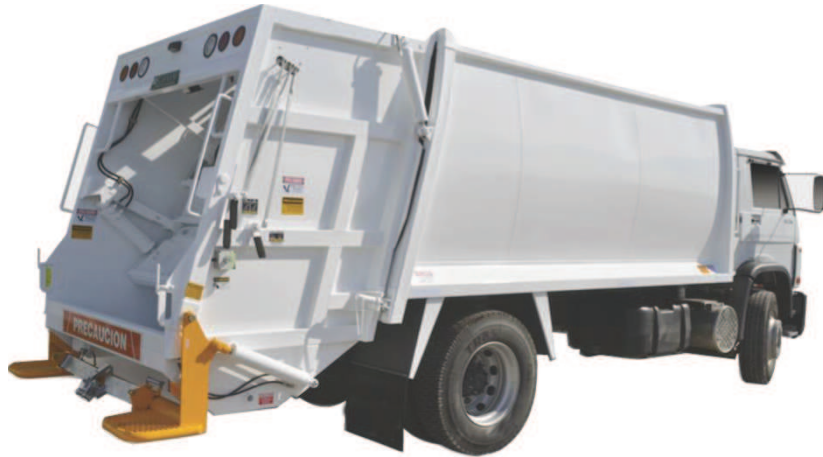
Figura 4.8: Ejemplo de camión compactador de carga trasera (“cola de pato”) de 2 ejes. Fuente: Econovo-Oscar Scorza Equipos y Servicios S.R.L.
