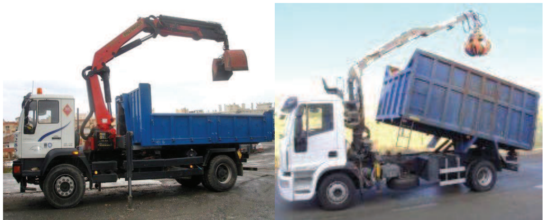
Figura 4.17: Ejemplos de camiones volcadores con almeja (izquierda) y garra-pulpo (derecha) hidráulicas integradas. Fuentes: El Quino-Excavaciones y materiales de construcción (izquierda) y Serveal Automoción (derecha).
